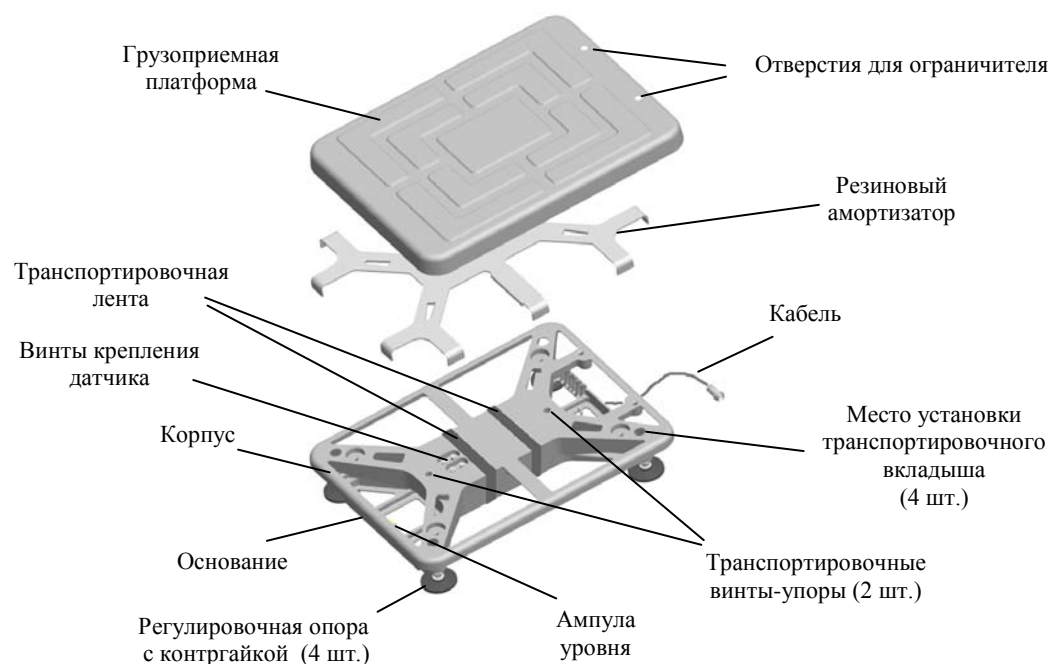
Рис. 4.1 – Модуль взвешивающий ТВ-S_
